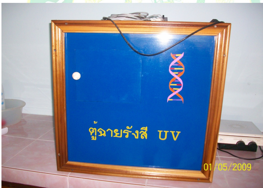
ภาพผนวกที่ 2 ตู้ฉายรังสีอัลตราไวโอเลต (Ultraviolet)
