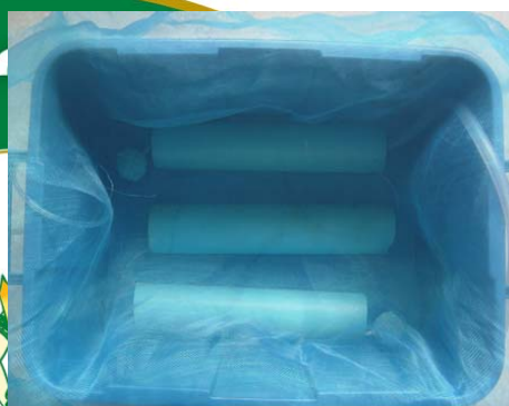
(ข) ป้อนมุ้งทับลงไปก่อนเติมทราย
