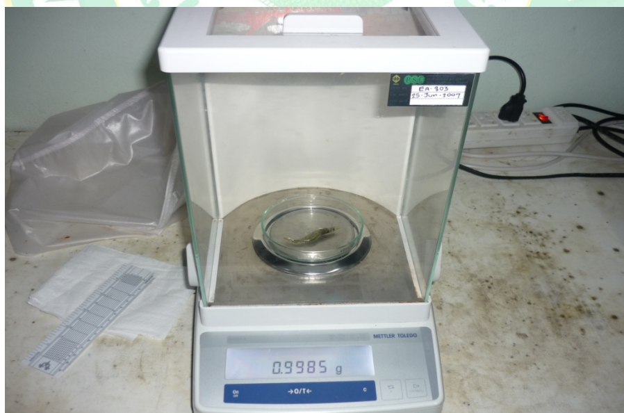
ภาพภาคผนวกที่ 10 การชั่งน้ำหนักลูกกุ้งเพื่อวิเคราะห์ผลการทดลอง โดยใช้เครื่องชั่ง ทศนิยม 4 ตำแหน่ง
