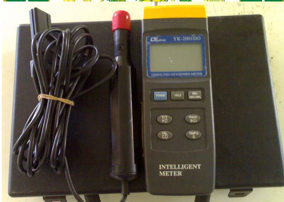
ภาพผนวกที่ 4 อุปกรณ์วัดค่าปริมาณออกซิเจนละลายน้ำ และอุณหภูมิ (DO meter)
