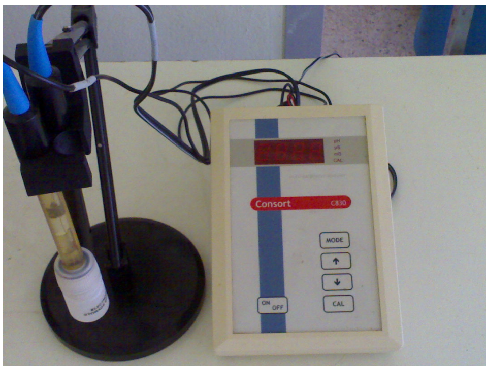
ภาพผนวกที่ 5 อุปกรณ์วัดค่าความเป็นกรด-ด่าง (pH meter)
