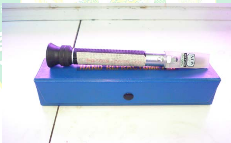
ภาพผนวกที่ 2 เครื่องวัดความเค็ม รุ่น NIPPON TOKYO 508-IIW
