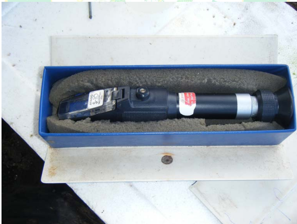
ภาพผนวกที่ 6 เครื่องวัดความเค็ม(Refracto Salinometer)
