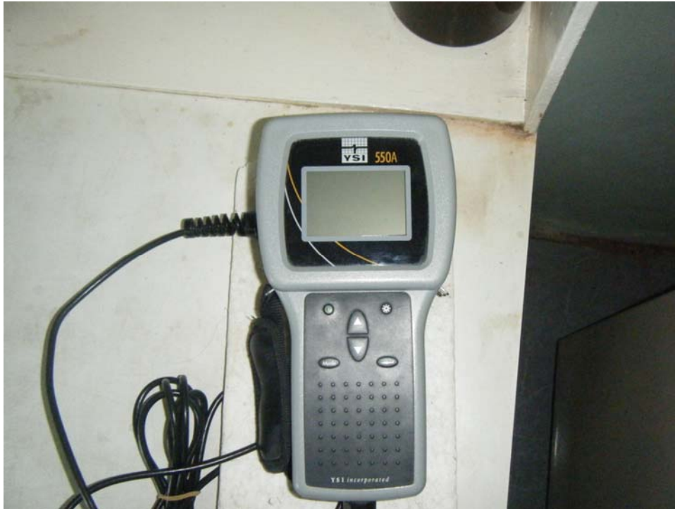
ภาพผนวกที่ 7 อุปกรณ์วัดค่าปริมาณออกซิเจนละลายน้ำ และอุณหภูมิ (Do meter)
