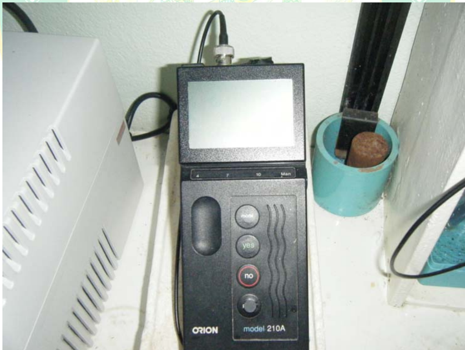
ภาพผนวกที่ 8 อุปกรณ์วัดค่าความเป็นกรด-ด่าง (pH meter)
