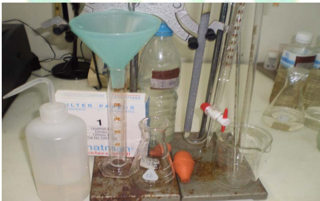
ภาพผนวกที่ 6 อุปกรณ์ที่ใช้วิเคราะห์คุณภาพน้ำ
