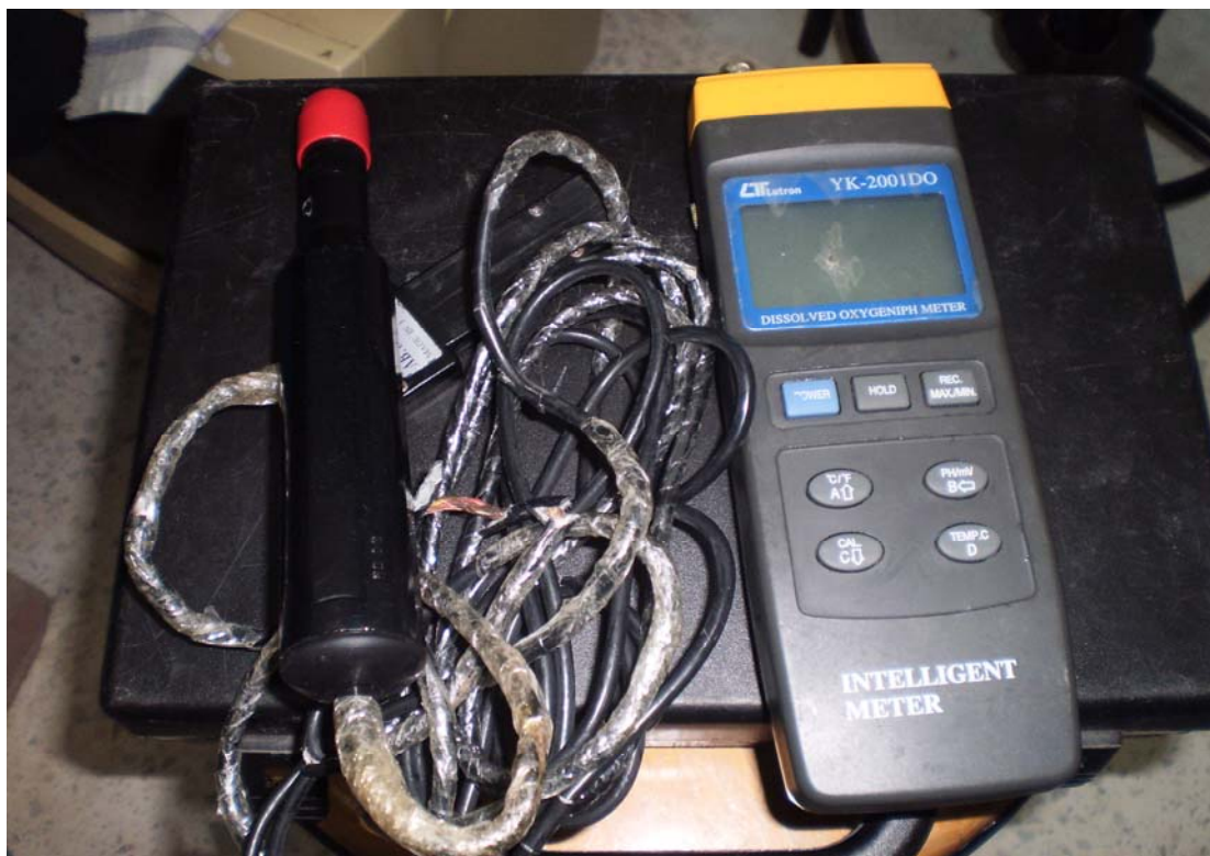
ภาพผนวกที่ 5 เครื่องวัดปริมาณออกซิเจนที่ละลายในน้ำ
