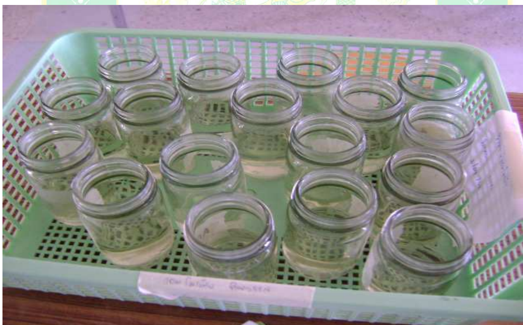
ภาพผนวกที่ 10 หลังจากเติมสารเคมีที่ใช้ในการวิเคราะห์แอมโมเนียในน้ำตัวอย่าง
