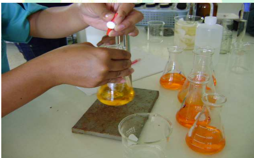
ภาพผนวกที่ 12 การไตเตรทหาค่าความเป็นด่างด้วย 0.02 \text{ N H}_2\text{SO}_4 (กรดซัลฟิวริก)
