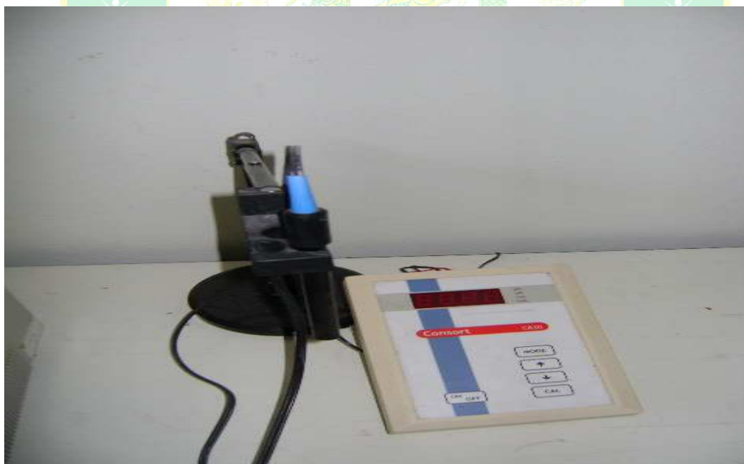
ภาพผนวกที่ 2 เครื่องวัดค่าความเป็นกรดเป็นด่าง (pH meter) รุ่น Contron C380
