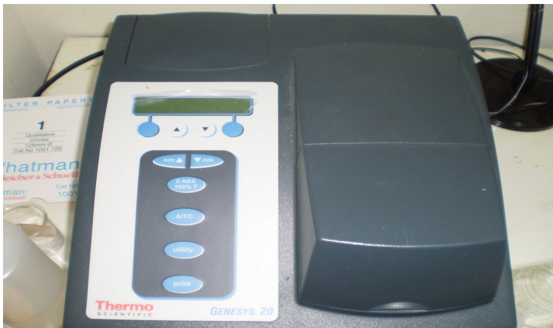
ภาพผนวกที่ 5 เครื่อง Spectrophotometer ที่ใช้ค่าของแอมโมเนียและไนไตรท์
