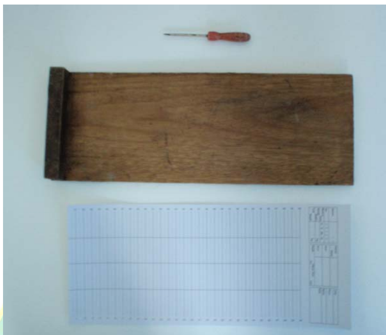
ภาพผนวกที่ 67 กระดาษวัดความยาวปลา พร้อมเหล็กปัก
