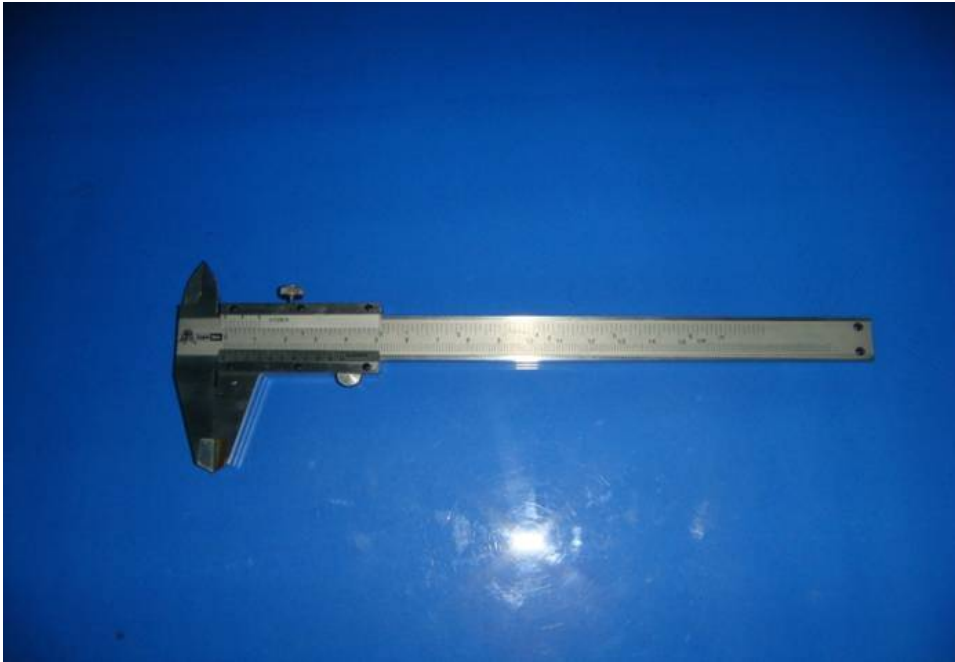
ภาพที่ 1 เวอร์เนียแคลิเปอร์ที่ใช้ในวัดขนาดความกว้างกระดองของปูทะเล
