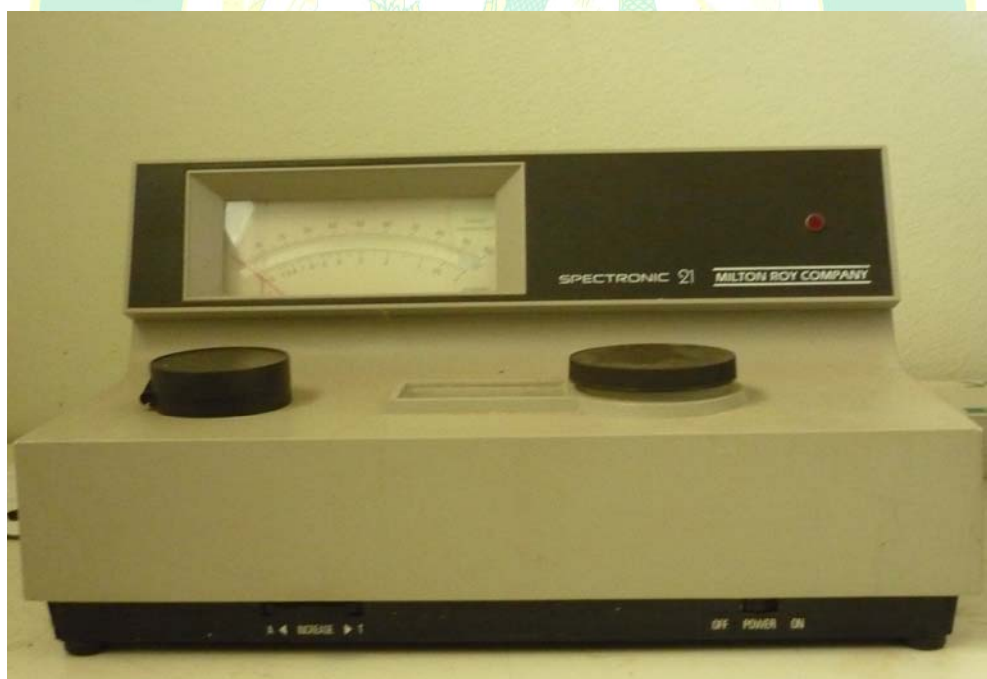
ภาพผนวกที่ 8 เครื่อง Spectrophotometer (ยี่ห้อ SPECTRONIC 21 MILTON ROYCOMPANY )
