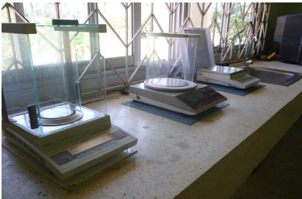
ภาพผนวกที่ 3 เครื่องชั่งสารเคมีที่ใช้ในการวิเคราะห์คุณภาพน้ำ
