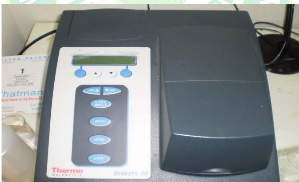
ภาพผนวกที่ 2 เครื่อง Spectrophotometer ที่ใช้ค่าของแอมโมเนีย ไนโตรที่ ออร์โทฟอสเฟต และไนโตรเจนรวม
