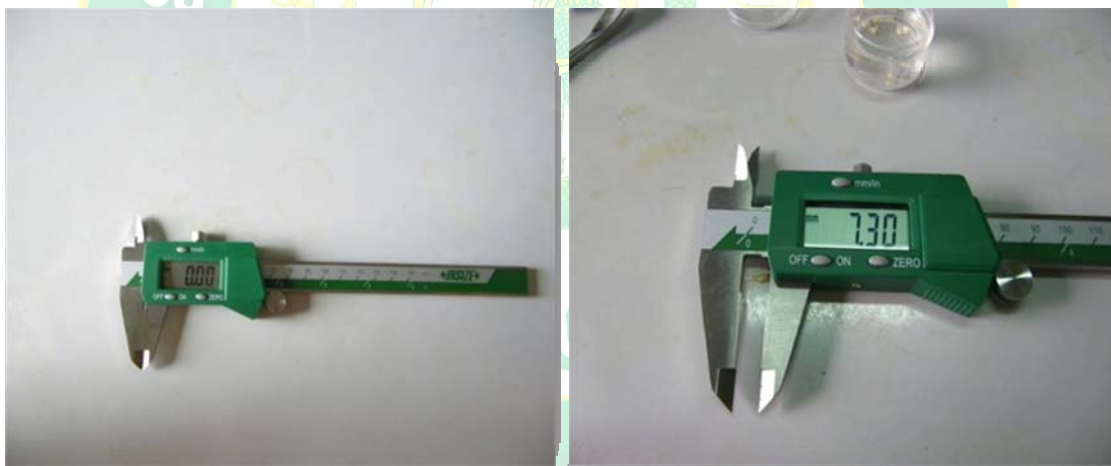
ภาพผนวกที่ 2 เวอร์เนียดิจิทัล INSIZE Digital Vernier ใช้ในการวัดขนาดความยาวลำตัวของ ลูกปลา
