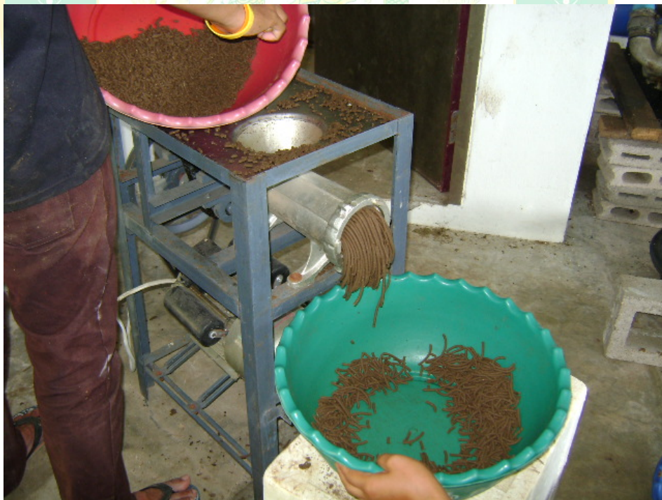
ภาพผนวกที่ 16 เครื่องบดอาหาร (mincer) และการบดอาหาร
