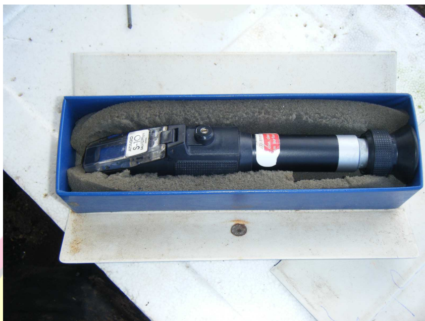
ภาพผนวกที่ 1 เครื่องวัดความเค็ม (Refracto Salinometer)
