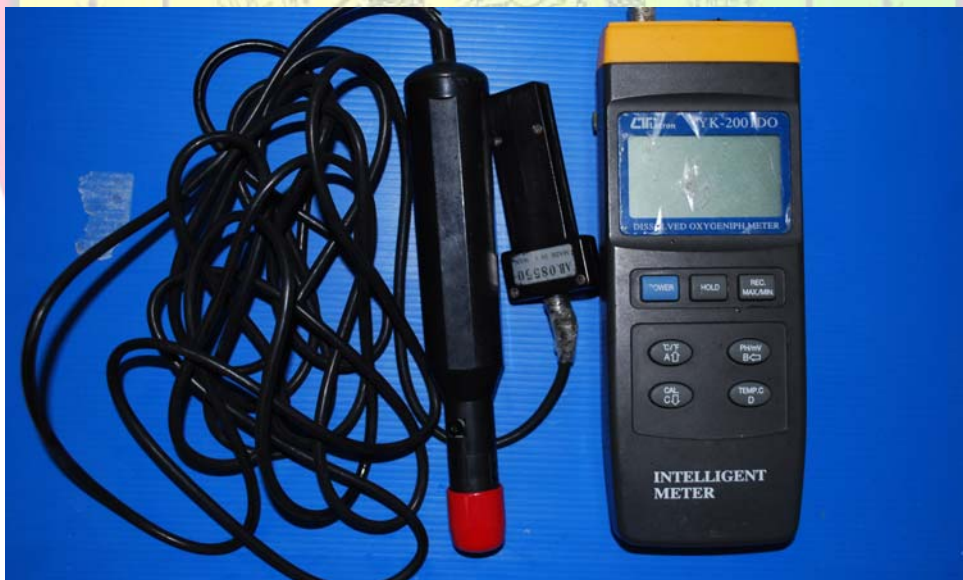
ภาพผนวกที่ 2 DO meter วัดค่าออกซิเจนที่ละลายในน้ำ (ยี่ห้อ LT Lutron รุ่น YK-200)
