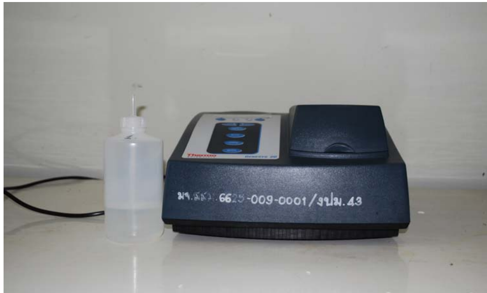
ภาพผนวกที่ 5 เครื่อง Specto photometer
