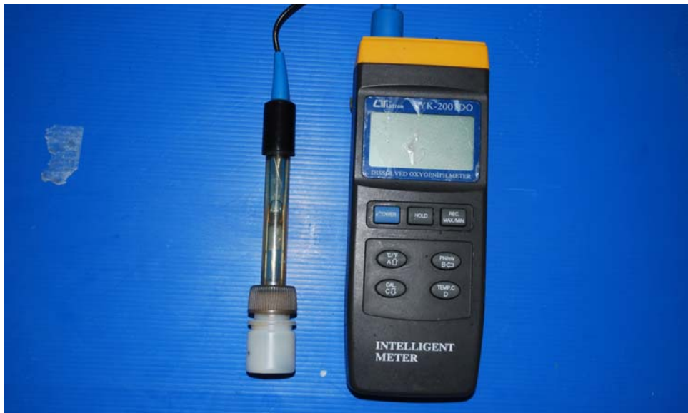
ภาพผนวกที่ 3 pH meter วัดค่าออกซิเจนที่ละลายในน้ำ (ยี่ห้อ LT Lutron รุ่น YK-200)
