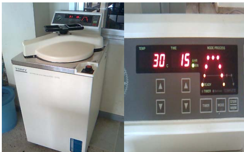
ภาพผนวกที่ 3 หม้อนึ่งความดันสูง (Autoclave) ยี่ห้อ TOMY รุ่น ES 315 และระยะเวลาที่ใช้ในการอบฆ่าเชื้อในดิน
