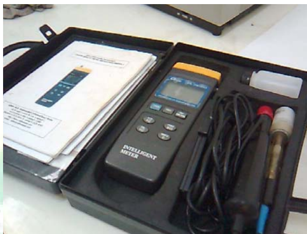
ภาพผนวกที่ 9 เครื่องวัดปริมาณออกซิเจน อุณหภูมิ และความเป็นกรด-ด่าง Water Quality Meter ยี่ห้อ Lutron YK 2001 DO
